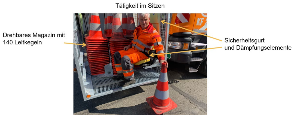
Neuer Arbeitskorb zum Setzen von Leitkegeln
